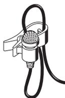
A l'aide du clip, vous pouvez fixer le micro cravate ME 2 aux vêtements (par ex. cravate, revers). Posez le câble de manière à éviter le bruit produit par frottement sur les vêtements et assurez-vous que l'antenne et le câble du micro ne se croisent pas. Le micro étant omnidirectionnel, il est inutile de le diriger avec une grande précision mais il doit être fixé aussi près que possible de la source sonore.
